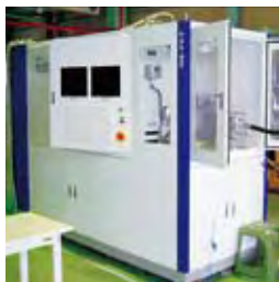
写真1 燃料電池評価装置 家庭のコジェネから自動車のフェセルセルテスターまで、商品化を見据えた開発に取り組む
