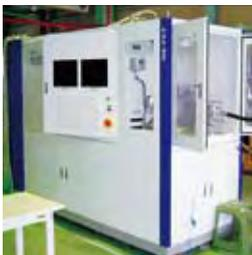
写真1 燃料電池評価装置
