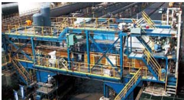
受賞技術が織り込まれたコークス炉診断・補修設備(DOC)
