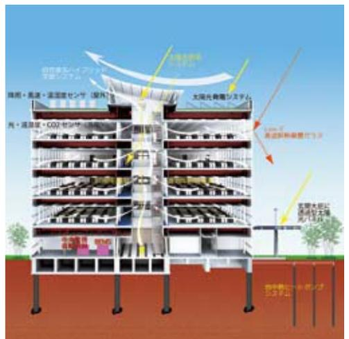
図4 少水量対応高効率地中熱利用ヒートポンプシステムの概要とエネルギー効率
