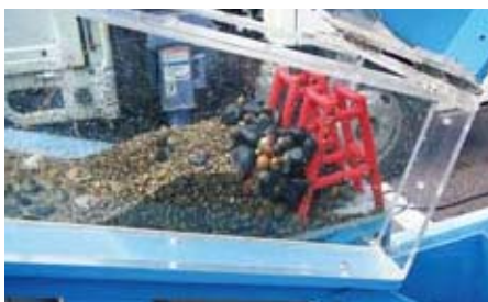
5月28日、社内教育の一環として砂防鋼構造物研究会の協力で鋼製スリットダムによる土石流捕捉のメカニズムを示す模型実験を実施
