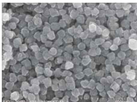
写真2 マイクロ波を用いて精密粒径制御されたニッケル微粒子 (平均粒径 60 ナノメートル)
