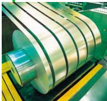
スリットした電磁鋼板を打ち抜き、積み上げてコアをつくる
