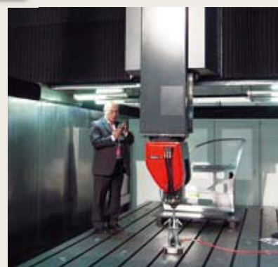
軽量の炭素繊維にすると自重が軽くなり、動作時の振動減衰性能が高まる
