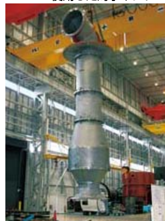
写真1 二相ステンレス鋼を使用した海水ポンプ
