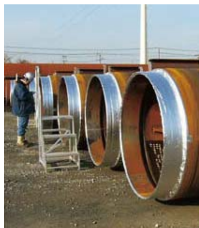
写真3 工場のヤードで出荷を待つラクニカンジョイント付高耐力継手鋼管矢板
