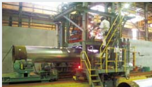
構造用鋼管に耐海水性ステンレス鋼(新日鉄住金ステンレス「NSSC270」)を巻いて溶接する
