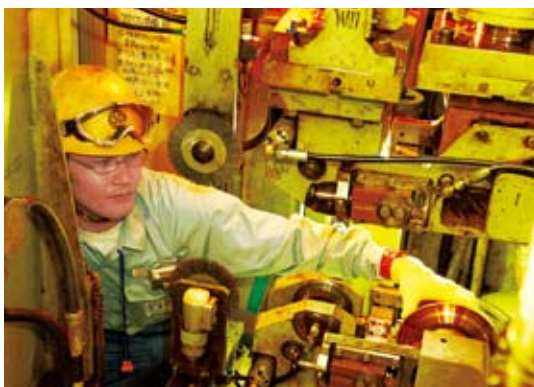
溶接機の電極輪をチェック
