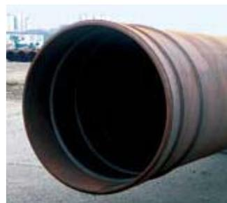
TN-X工法向け鋼管杭の先端部分
