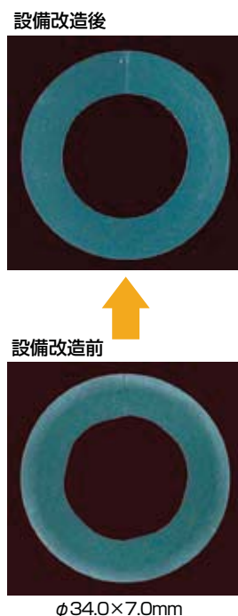
写真1 内面形状の改善状況
