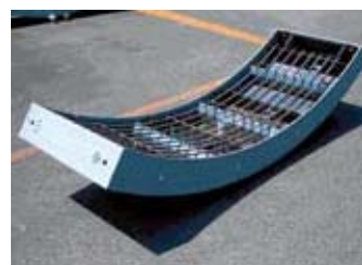
コンクリート中詰め合成セグメントの鋼殻
