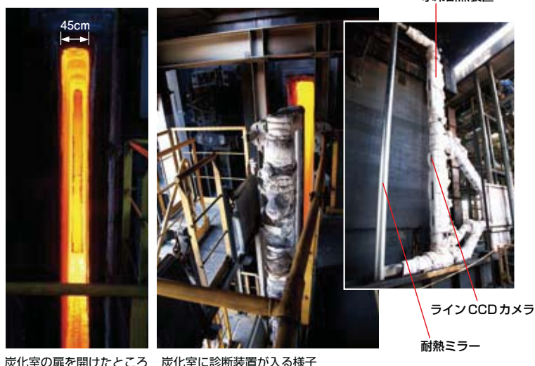
写真2 診断装置の炭化室への挿入
