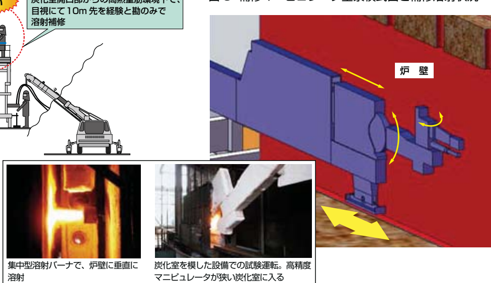
図6 補修マニピュレータ全景模式図と補修溶射状況
