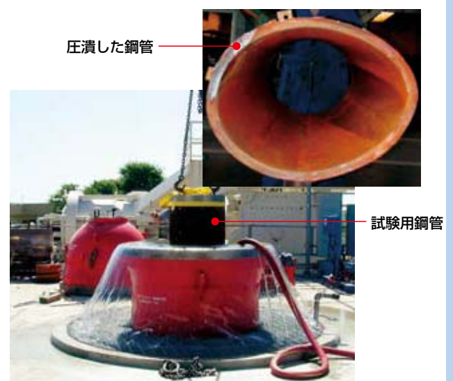
水を満たした圧力容器に試験用鋼管を入れるところ。その後蓋をして鋼管が圧潰するまで水圧を高める。
