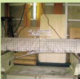
図4 ストランドシートによるRCはり曲げ補強効果
