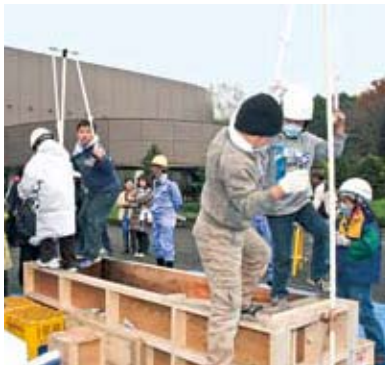
足踏みふいご。シーソーのように両端に分かれ、交互に力強く踏み込み炉に風を送る
