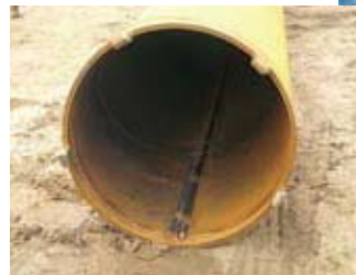
掘削ビット付き鋼管杭
