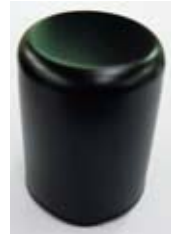
ジンコート®ブラックの加工例(円筒絞り成形)
