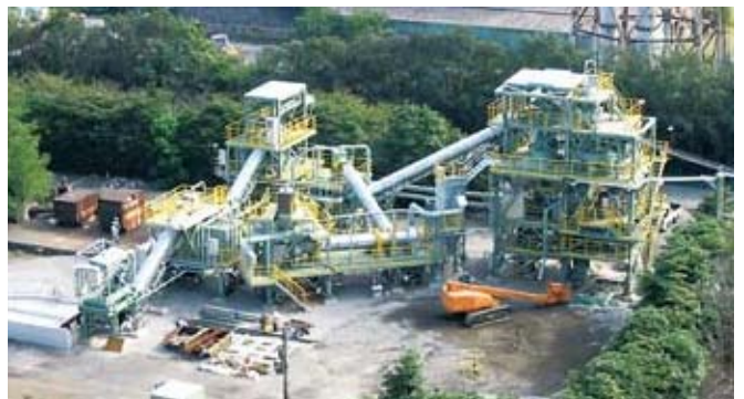
使用済み耐火物の破碎・粉砕プロセス(大分製鉄所)
