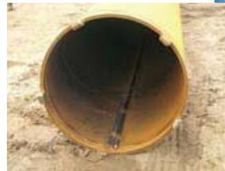
掘削ビット付き鋼管杭
