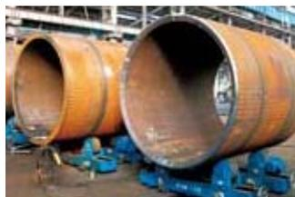
BT-HT500C(板厚100mm)を用いた円形鋼管
