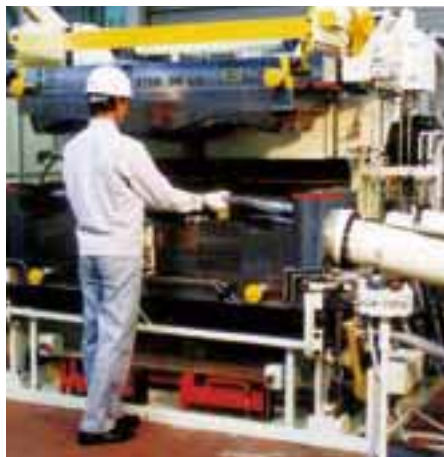
コンパクト型 hidroフォーミング設備
