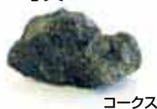
新日鉄では石炭品質が多様化する中で、さまざまな特性を持つ石炭の複雑な配合（コール・ブレンド）を最適化してコークスの粘結性を高め、還元材品質の安定化に取り組んでいる。
