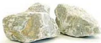
炭酸カルシウム（ $\text{CaCO}_3$ ）を主成分とする鉱物。高炉内で鉄鉱石に含まれる不純物と結合し、「スラグ」として無害化する。高品質な銑鉄を得る上で不可欠な副原料だ。
