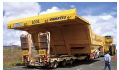
採掘された鉄鉱石を運搬するトラックから荷台だけをはずして台車に乗せて一般道路を輸送する。
