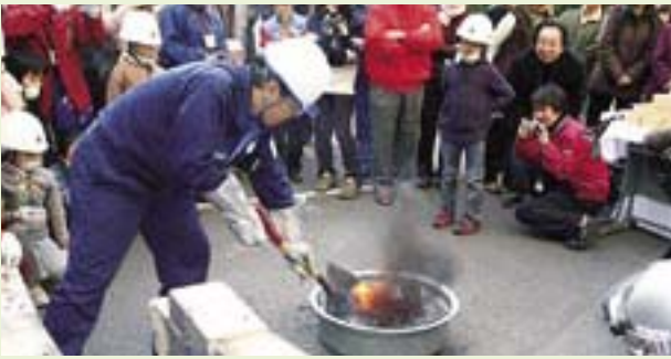
炉の中からケラを取り出す。水に入れ「ジュワッ」という音と同時に水蒸気が上がると、子どもたちから歓声が上がった 1班は6.6kg、2班は7.9kgと立派なケラがで上がった
