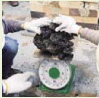
炉の中からケラを取り出す。水に入れ「ジュワッ」という音と同時に水蒸気が上がると、子どもたちから歓声が上がった 1班は6.6kg、2班は7.9kgと立派なケラがで上がった
