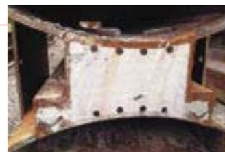
モルタル充填後の「Super Junction」の断面
