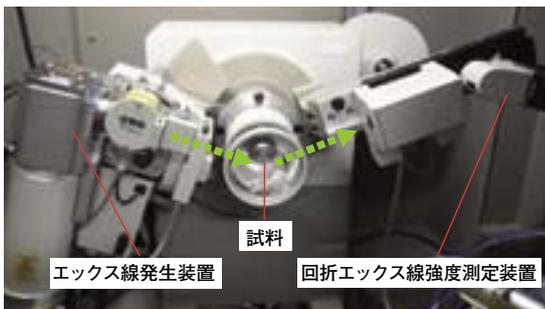
エックス線回折法は、エックス線の回折角度の測定から、原子の配列構造を調べる。
