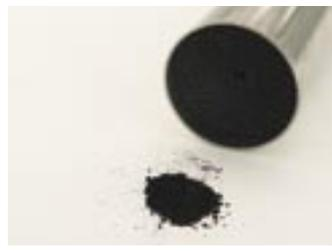
排ガス浄化装置用メタルハニカムと新型触媒
