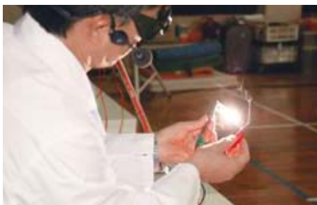
単三電池63個を使用し、接触させた瞬間にアーク放電で閃光とともに5,000~6,000℃の熱を発生し、カッターの刃があっという間に溶ける
