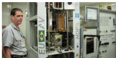
めっき品質検査装置。鉄鋼研究所との協業を通して品質の向上を実現している
