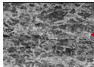
低温で圧延されて、変形帯やレッジを含むオーステナイトから変態したフェライト
