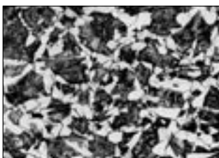
高温で圧延されて、再結晶しオーステナイトから変態したフェライト
