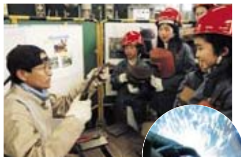
半自動溶接 (CO 2 溶接): 手元のスイッチを押すとノズルの先から溶接ワイヤが出てきます
