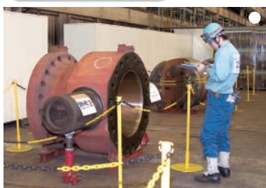
質量目測・ワイヤー選定 鋼材4個の質量を目測し、異なる径のワイヤーロープの中から最適なものを選定する。
