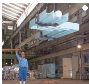
玉掛け 補助員に的確な指示をしながら安全でバランスのとれた玉掛けを行う。
