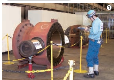
① 質量目測・ワイヤー選定 鋼材4個の質量を目測し、異なる径のワイヤーロープの中から最適なものを選定する。
