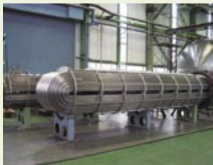
写真2 化学プラント/熱交換器 (提供:トーホーテック(株))
