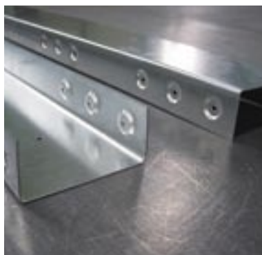
同社が先駆けて開発・導入したNSF用設備で製造した先孔エンボス形鋼
