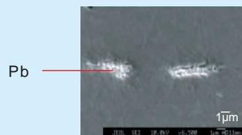
鋼中に分散するマンガンの硫化物 写真9
