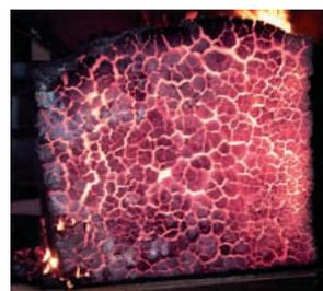
試験コークス炉から排出した直後のコークス。サイズは小さい(高さ1m、長さ1m、幅0.45m。実機は高さ約6m、長さ約15m、幅0.45m)が、実機コークス炉では、コークスは炉から出ると落下してバケット(コークスを受ける容器)に落ちるので、このような状態で見ることができない。
