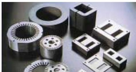
ハイブリッドカー用高効率電磁鋼板
