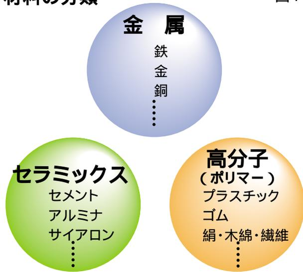
あらゆる物質は力を加えると、形状・容積が変化する。その観点について、「金属」「セラミックス」「高分子」の3材料の物性を比較してみよう。
