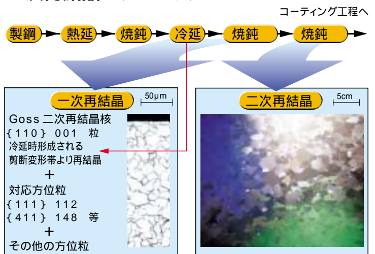
二次再結晶のプロセス 図2
