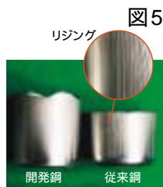
高加工性とリジング低減を両立した開発鋼の円筒深絞り後の外観
