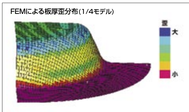
図9 成形シミュレーション
