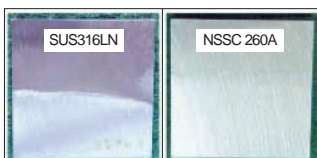
粗製りん酸による鋼板変色の比較
