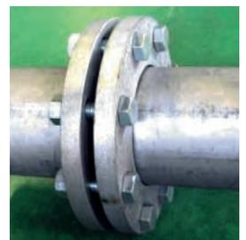
写真2 フレア加工の接続写真
