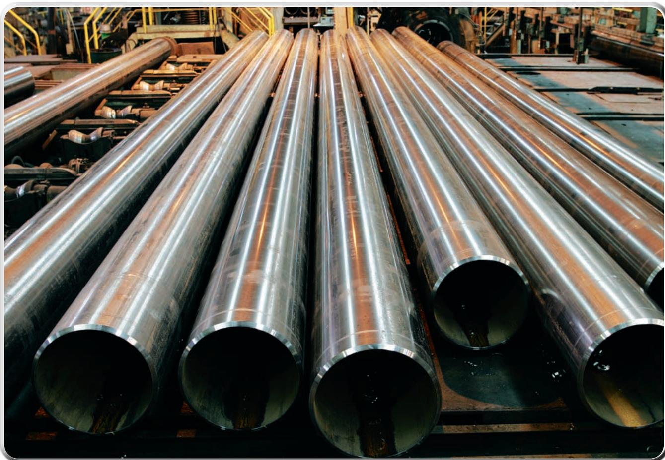
鋼管は、筒状に成形された圧延鋼材だ。主に中間加工品として用いられ、その用途は水道管、ガス管など身の回りのものから化学プラント、火力・原子力発電設備、土木・建築、各種産業機械まで多岐にわたる。年々拡大する鋼管の対応分野の中で、最も多いのがエネルギー分野だ。その市場ニーズは(1)省コスト(2)環境保全(3)安全性(4)景観性の4つのキーワードに分類することができる。
