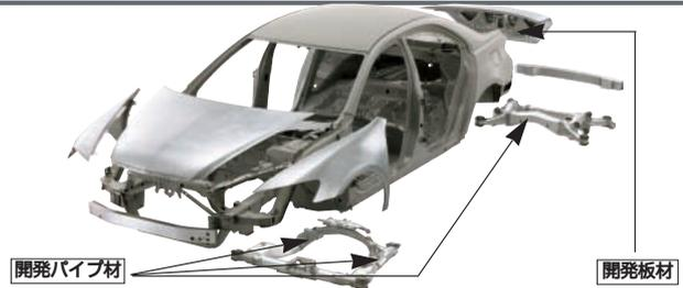
自動車サブフレーム用の5000系アルミニウム合金パイプ
