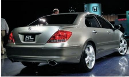
新日鉄、古河スカイ㈱、本田技研工業㈱共同開発のアルミニウム合金が、新型レジェンドに採用された。「新高温ブロー成形用の5000系アルミニウム (Al-Mg系) 合金板」がトランクリッド・フレームに、
