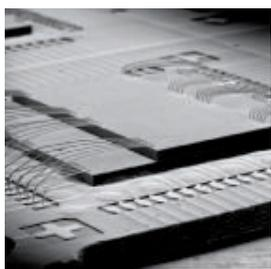
多くの電気信号を効率よく出す「ファインピッチBGA（ボール・グリッド・アレイ）タイプ」(写真上)の採用が拡大している。ここに㈱日鉄マイクロメタルのボンディングワイヤ（リ
