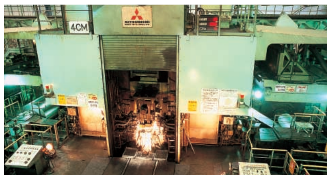
光製造所 薄板工場／NO.4冷間圧延機
