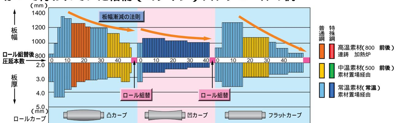
最初のコイル10本位は、板幅の狭いものから幅広に移行し、その後の約90本は、徐々に板幅を狭くしていく。徐々に生じるロール摩耗に合わせて、形状制御が容易な狭い板幅に移行させていく。
