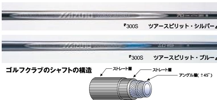
けでなく、回転方向の「ねじれ」などの力がかかる。また、初心者とプロでは部位ごとに求められる特性が異なる。ゴルフクラブメーカーは、さまざまな弾性率、強度などを持つ繊維を適切に組み合わせ、従来よりも軽くて打ちやすくしかも飛距離が伸びるクラブを開発している。ゴルフクラブメーカーのこうした高度な設計ニーズにきめ細かく応えているのがNGF製のピッチ系炭素繊維で、シャフトの先端部や手元部などの重要部分に使われている。
