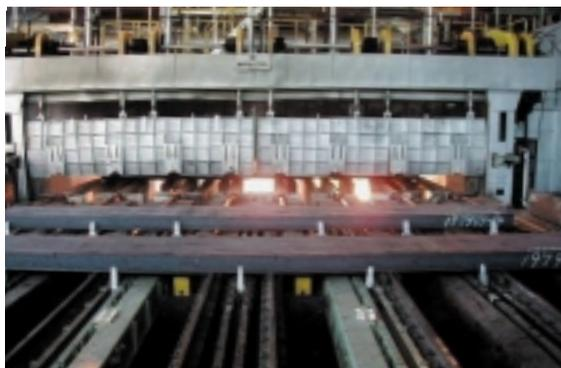
エネルギー効率の高いリジネバーナー方式の加熱炉
