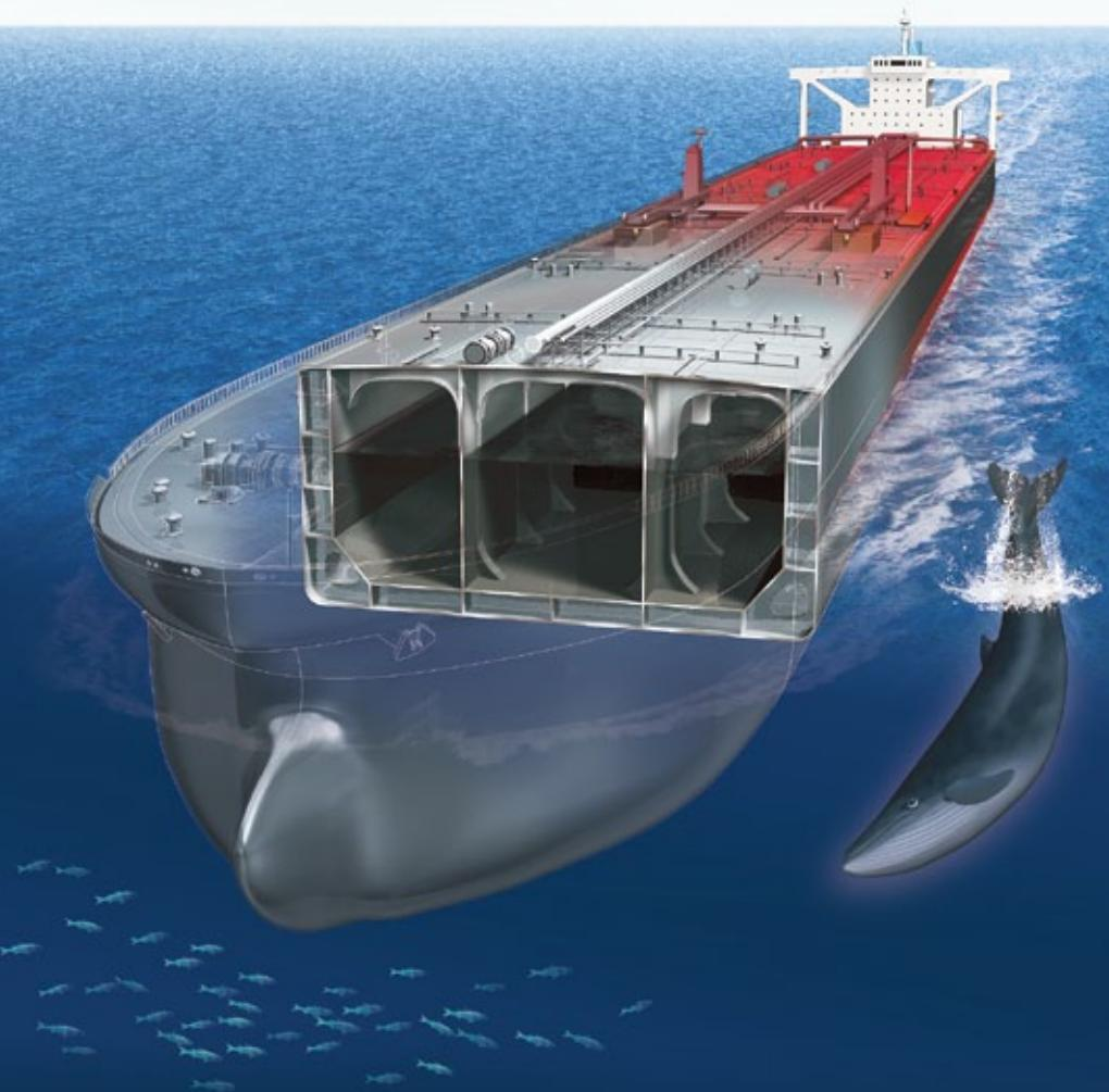
船やビル、橋などの大型構造物に欠かせない鋼板「厚板」。過酷な条件下に耐える高い強度や粘り強さを備えた最も重量感のある鋼材です。新日鐵住金は、原油タンカーの側面に、衝突された際に衝撃を吸収し船の破損を抑える厚板、タンク用には腐食に強く原油漏れを防ぐ厚板を開発。進化した鉄が、船の安全と海の環境を守ります。
